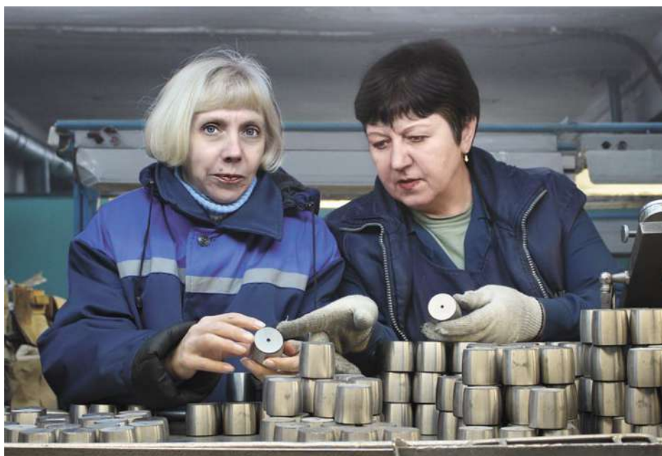
Контрольный мастер участка ЦКИ Л.В. Курец и контролер станочных и слесарных работ М.В. Тышкевич обсуждают дефекты в процессе внешнего контроля роликов
