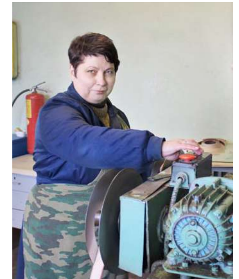
В обязанности одного из лучших работников участка бакелизаторщика Е.И. Донюш входит большое число обязанностей: разрыв шлифполотна на полосы, намазка шлифполотна; осернение шлифкругов, пропитка их ацетоном-бакелитовым раствором и мн.др.
