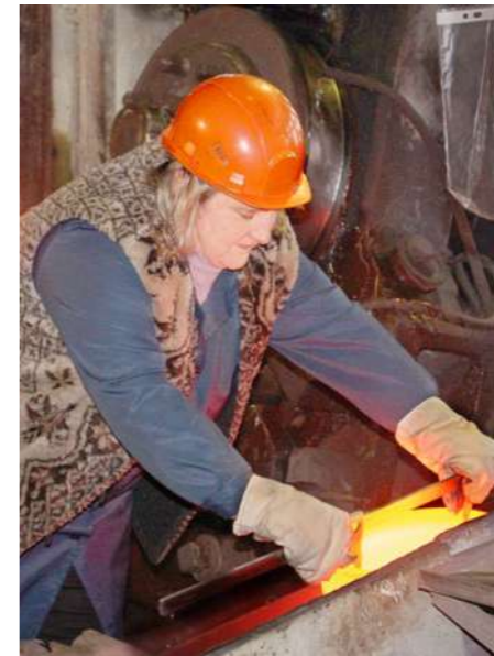
Контролер кузнечно-прессовых работ Н.Г. Корнеева проводит межоперационный контроль поковок колец на участке молотового кузнечно-прессового оборудования
