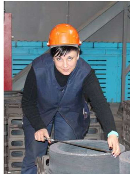
Контролер кузнечно-прессовых работ Д.Б. Антонюк проверяет параметры поковок колец после раскатки и отжига на участке автоматизированного производства поковок
